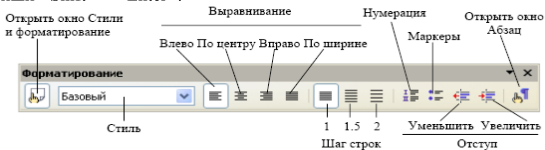
Рисунок 9 – Панель с кнопками для форматирования абзаца
